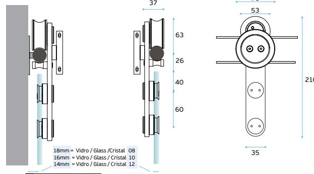
Medidas dos furos a efectuar no vidro / Sizes of the holes to be made in the glass / Medidas de los taladros en el cristal.
